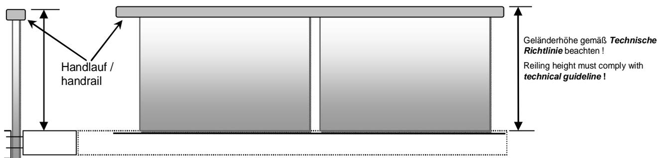
**Hinweis:** Bei Verwendung von VSG aus 10 mm ESG + 1,52 mm PVB/SGP + 10 mm ESG oder VSG aus 10 mm TVG + 1,52 mm PVB/SGP + 10 mm TVG in den Abmessungen gemäß Tabelle B ist nur ein statischer Nachweis erforderlich.
